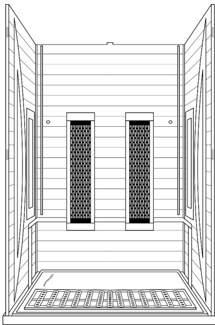
Platzieren Sie die rechte Seitenwand rechtwinkelig zu der Rückwand. Achten Sie dabei darauf, dass sich die Seitenwand mit der Rückwand korrekt verbindet.
