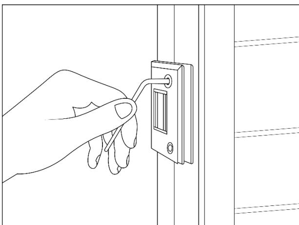
Ziehen Sie bitte die Schrauben der Scharniere der Glastür mit Hilfe des 4 mm Sechskantschlüssels (Inbus) nach. Gegebenenfalls können Sie die Glastür noch feinjustieren, indem Sie alle Schrauben ein wenig lockern und, am besten zu zweit, die Glastür einrichten.
