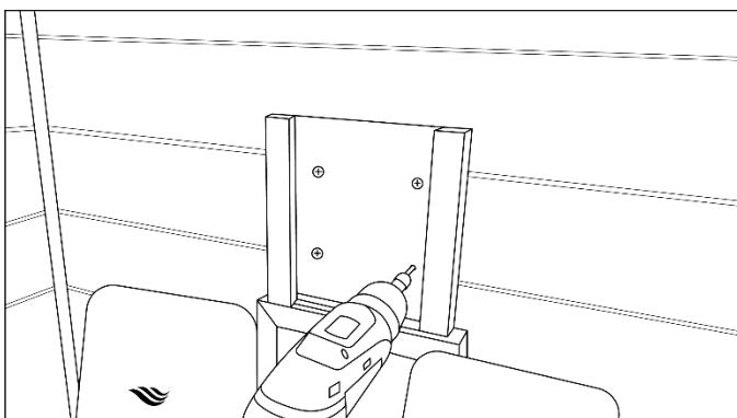
Positionieren Sie das Brett der Kopfstütze mittig oberhalb des Rückenstrahlers zwischen den flexiblen ergonomischen Rückenlehnen und schrauben Sie diese mit den mitgelieferten Schrauben (**4 Stück 30 mm**) an die Rückwand. Anschließend verdecken Sie die Löcher mit den mitgelieferten Abdeckungen und schieben die Kopfstütze in die Führungsschienen.
