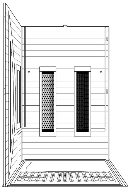
Platzieren Sie die linke Seitenwand rechtwinklig zu der Rückwand auf den Boden so, dass die Aussparungen passen. Heben Sie die Seitenwände an, bis die Metallbolzen in der Höhe der Löcher der Einhängevorrichtung sind. Drücken Sie die Seitenwand an die Rückwand und achten Sie darauf, dass die Metallbolzen in die Einhängevorrichtungen einrasten. Die Seitenwand und die Rückwand müssen oben plan abschließen.
