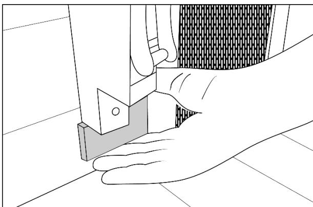
Halten Sie die Schablone jetzt unten an, um den Abstand von 4 cm unten zwischen Holzsteg und Rückenstrahler einzuhalten. Schrauben Sie den Steg unten und mittig mit **2 Stück 40 mm** Schrauben fest.
