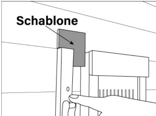
Für links und für rechts gibt es unterschiedliche Holzstege (mit drei Kunststoffhalterungen), die jeweils nach innen zeigend montiert werden müssen. Klemmen Sie die mitgelieferte Schablone zwischen Infrarotstrahler und Holzsteg sodass diese einen Abstand von 4 cm haben. Die Holzstege müssen mit dem Rückenstrahler oben plan abschließen. Schrauben Sie jetzt den Steg oben mit **einer 40 mm Schraube** an.
