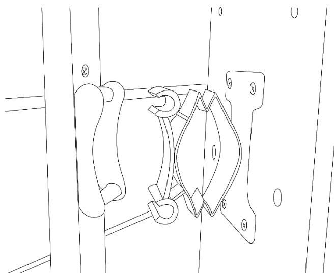
Nehmen Sie die flexiblen Rückenlehnen mit der Wölbung nach unten und verbinden Sie die Kunststoffelemente durch vorsichtiges ruckartiges Drücken miteinander. Die Elemente rasten mit einem Klickgeräusch ein. Überprüfen Sie, dass alle Elemente korrekt verbunden sind.
