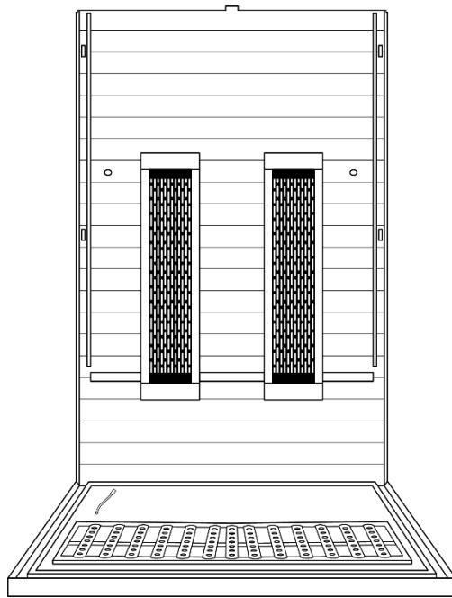
Stellen Sie die Rückwand mit den Infrarotstrahlern nach innen auf die Bodenplatte in die dafür vorgesehene Aussparung. Dabei sollte die Rückwand seitlich mit den Leisten der Bodenplatte abschließen.
