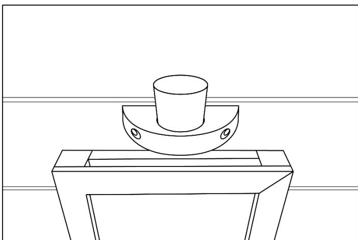
Die Halterung mit dem Glasschälchen sollte mittig über einem Tiefenwärmestrahler montiert werden (**2 Stück 40mm Schrauben**). Der Abstand zwischen dem Strahlerrahmen und der Halterung muss mindestens 2cm betragen. Wir empfehlen, die Löcher mit einem 3 mm Holzbohrer vorzubohren.
