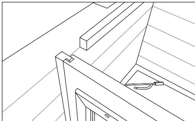
Schieben sie den Wadenwärmestrahler in die seitlichen Führungsschienen. Der Strahler muss dabei, wie abgebildet, in Ihre Richtung zeigen.
