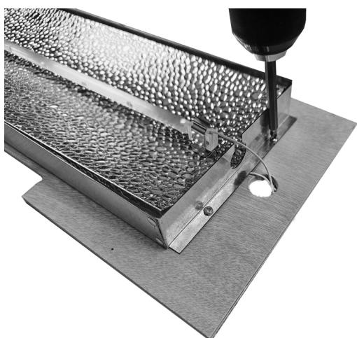
Schrauben Sie jeweils oben und unten an einer Seite den kleinen Schrauben auf und entfernen Sie das Kabel welches zwischen dem Reflektor und dem Holzbrett eingeklemmt ist.
