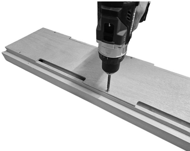
Schrauben Sie die sechs Schrauben auf der Rückseite des Infrarotstrahlers auf und heben Sie die Platte mit dem Infrarotstrahler weg.
